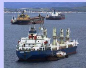
Descarga de Fuel de un buque a otro → Bunkering → Fuente de contaminación importante.
